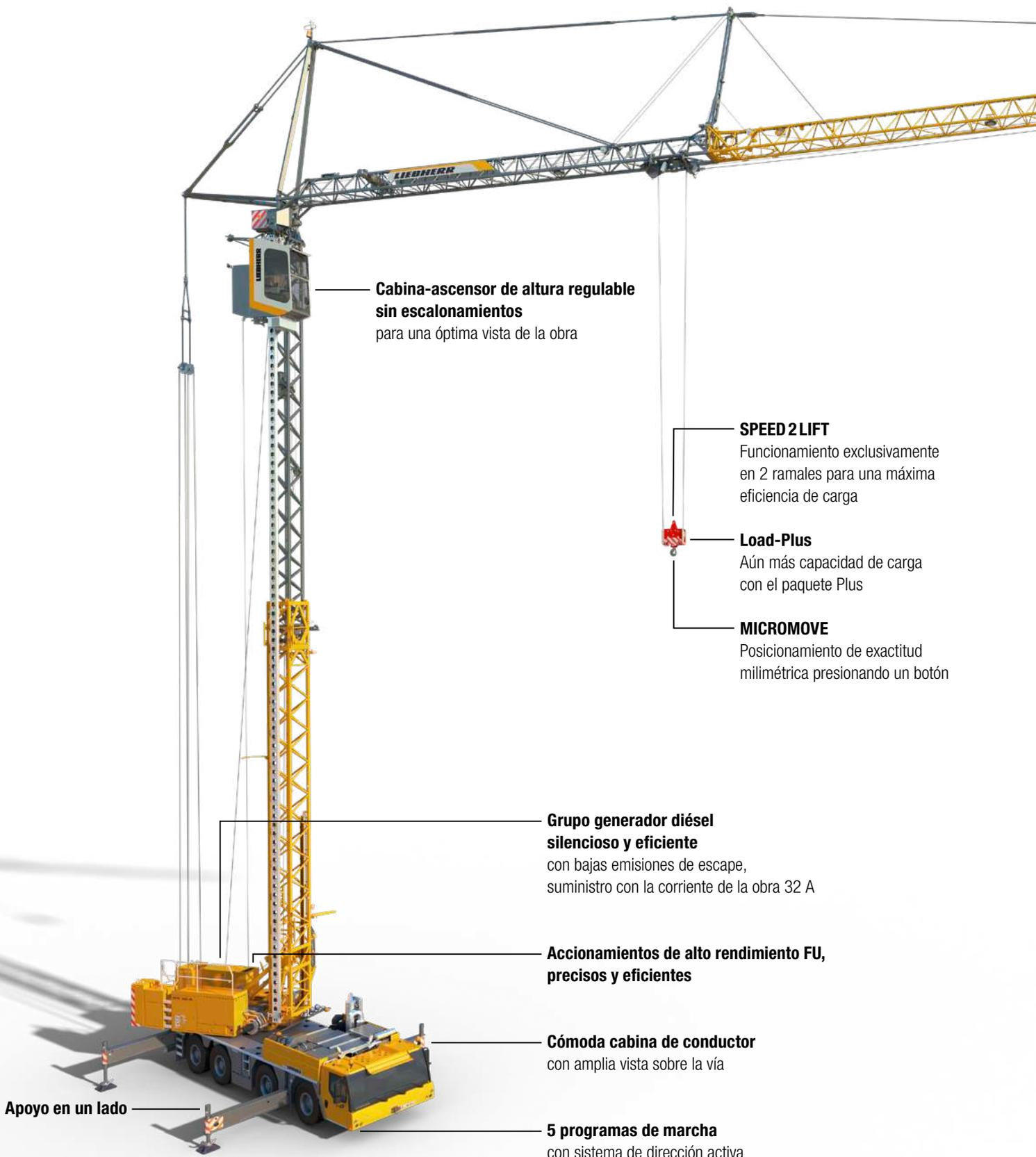
**Cabina-ascensor de altura regulable sin escalonamientos**
