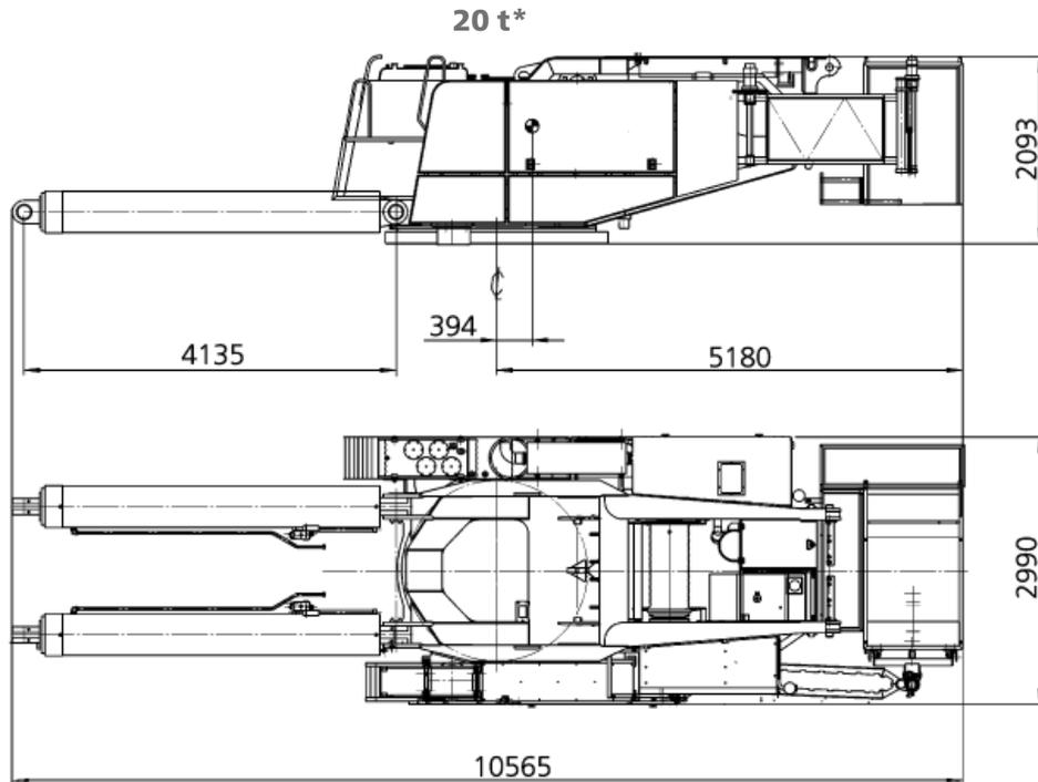
\* incl. luffing cylinder · inkl. Wippzylinder · avec vérin de relevage · incl. cilindro di impennatura · incl. cilindro de elevación ·
